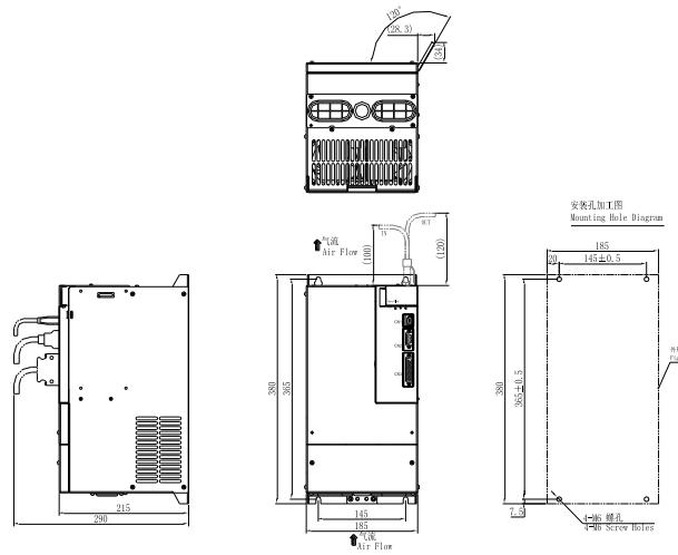
图 3.1.7 伺服驱动器结构尺寸 5
