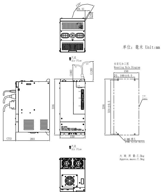
图 3.1.6 伺服驱动器结构尺寸 4
