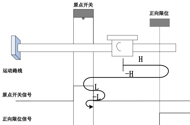
开始回零时 ORGP=0, 以正向高速开始回零, 遇到限位开关, 自动反向, 反向高速运行, 遇到 ORGP 上升沿后, 减速反向即恢复正常运行, 正向低速遇到 ORGP 下降沿后, 反向, 反向低速运行中遇到 ORGP 上升沿折返到上升沿;
