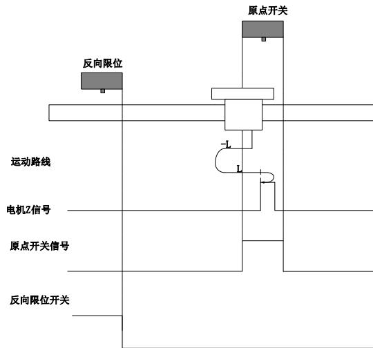
回零启动时 ORGP=1，则直接反向低速开始回零，遇到 ORGP 下降沿后，反向，正向低速运行中，遇到 ORGP 上升沿后 Z 信号折返到 Z 信号；
