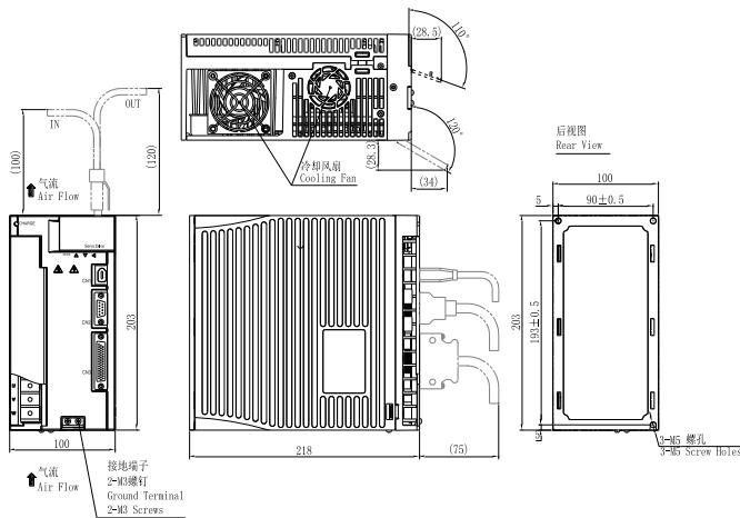
图 3.1.5 伺服驱动器结构尺寸 3
