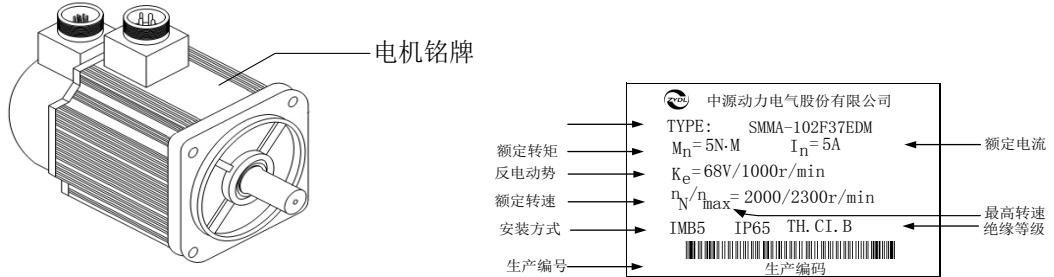
图 2.2.3 伺服电机铭牌示意图（7.5KW 以下）
