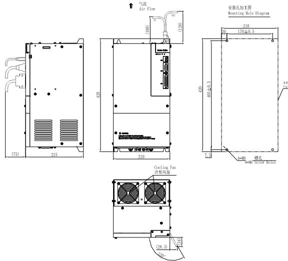
图 3.1.8 伺服驱动器结构尺寸 5
