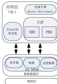
图 6.3.1 基于 CANOpen 应用层的 EtherCAT 通信结构
