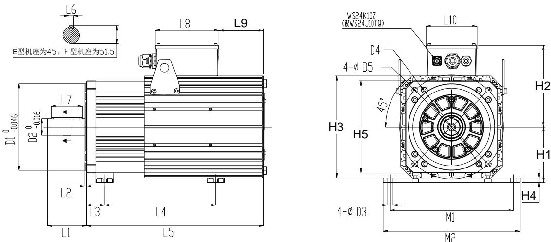
图 3.2.7 伺服电机安装尺寸
