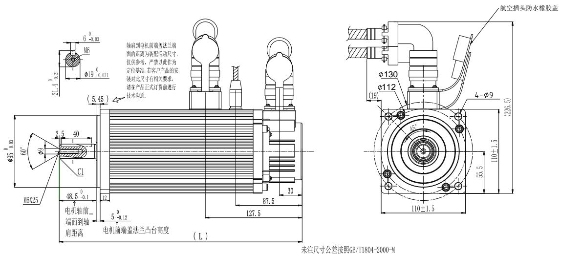
图 3.2.3 110 法兰伺服电机安装尺寸
