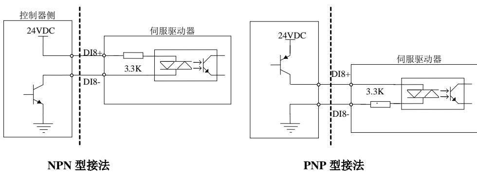
图 4.3.15 DI8 接线图示
