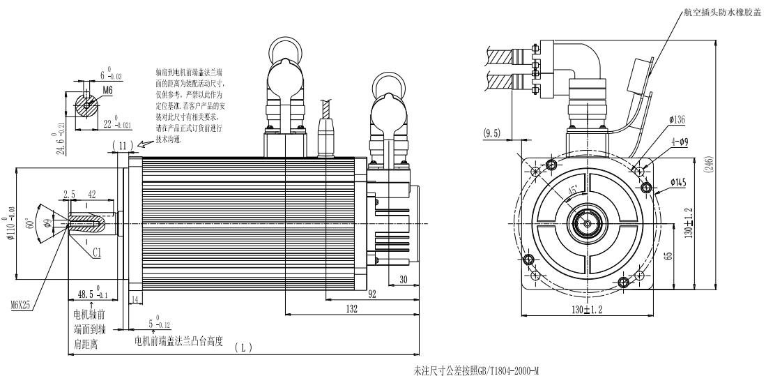
图 3.2.5 130 法兰伺服电机安装尺寸
