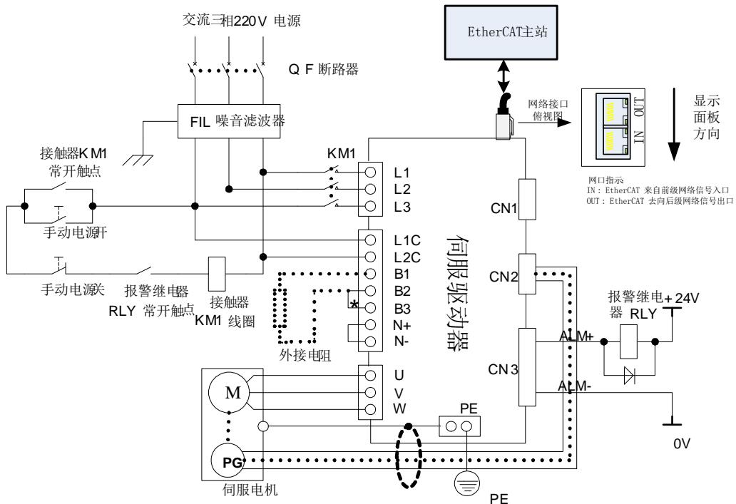
图 4.1.4 220V 驱动器典型主电路配线图
