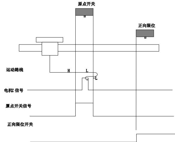
开始回零时 ORGP=0, 以正向高速开始回零, 若未遇到限位开关, 遇到 ORGP 上升沿后, 减速, 正向低速运行, 遇到 ORGP 下降沿后, 反向, 反向低速运行, 遇到 ORGP 上升沿后的 Z 信号折返到 Z 信号;
