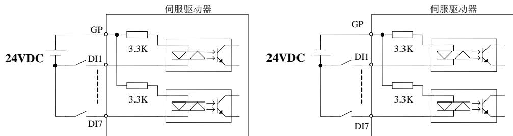
图 4.3.13 无源接点接口电路
