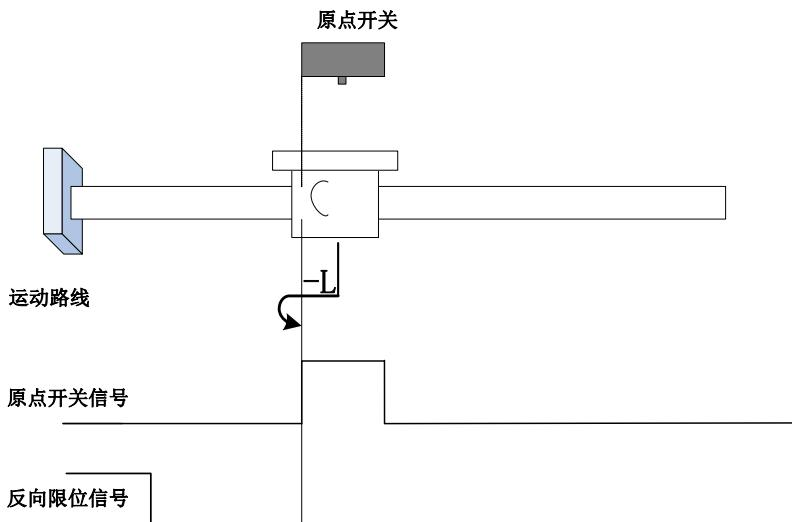
回零启动时  $ORGP=1$ , 则直接反向低速开始回零, 遇到  $ORGP$  下降沿折返点下降沿;
