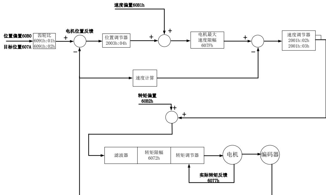
图 7.6.1 周期同步位置 (CSP) 控制框图
