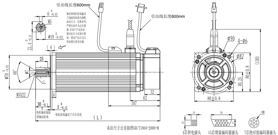
图 3.2.2 80 法兰伺服电机安装尺寸
