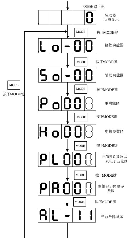
图 5.2.1 用户参数区切换示意图
