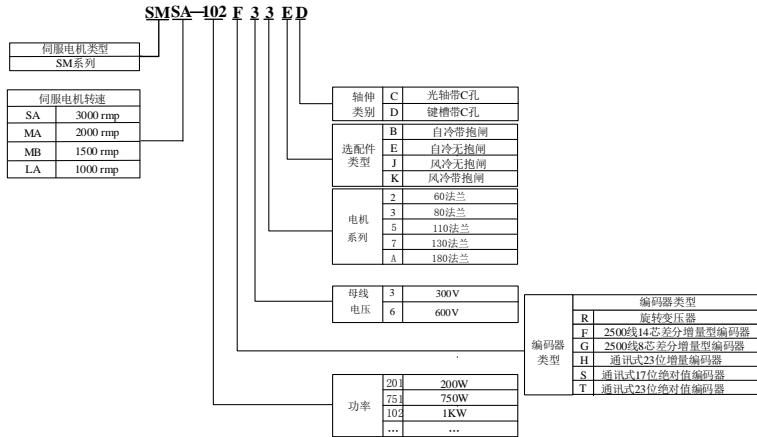
图 2.2.1 伺服电机命名规则（180 及以下法兰电机）
