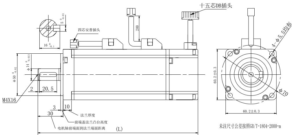
图 3.2.1 60 法兰伺服电机安装尺寸
