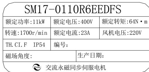
图 2.2.4 伺服电机铭牌示意图（11KW 以上）
