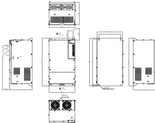
图 3.1.9 伺服驱动器结构尺寸 6
