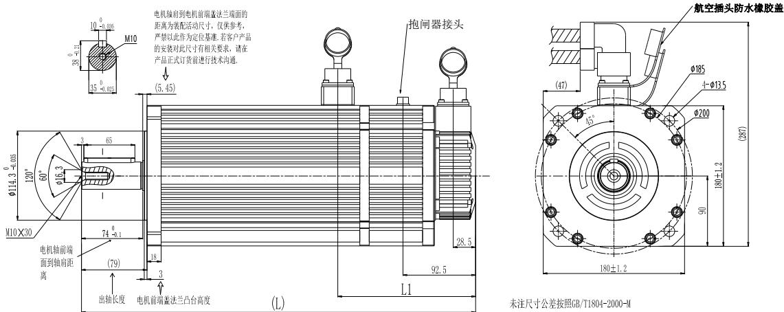
图 3.2.6 180 法兰伺服电机安装尺寸
